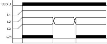
Если все фазы подключены с правильной очередностью, а измеряемая асимметрия будет меньше чем заданное установочное значение на переключателе ASYM, исполнительное реле R включается (загорается желтый светодиод). Когда очередность фаз изменяется, исполнительное реле R выключается (желтый светодиод не светится).
